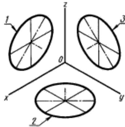
1 — эллипс (большая ось расположена под углом  $90^\circ$  к оси  $y$ ); 2 — эллипс (большая ось расположена под углом  $90^\circ$  к оси  $z$ );
