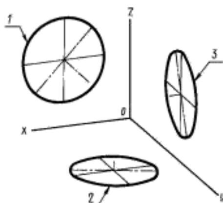
1 — эллипс (большая ось расположена под углом  $90^\circ$  к оси  $y$ ); 2 — эллипс (большая ось расположена под углом  $90^\circ$  к оси  $z$ );
