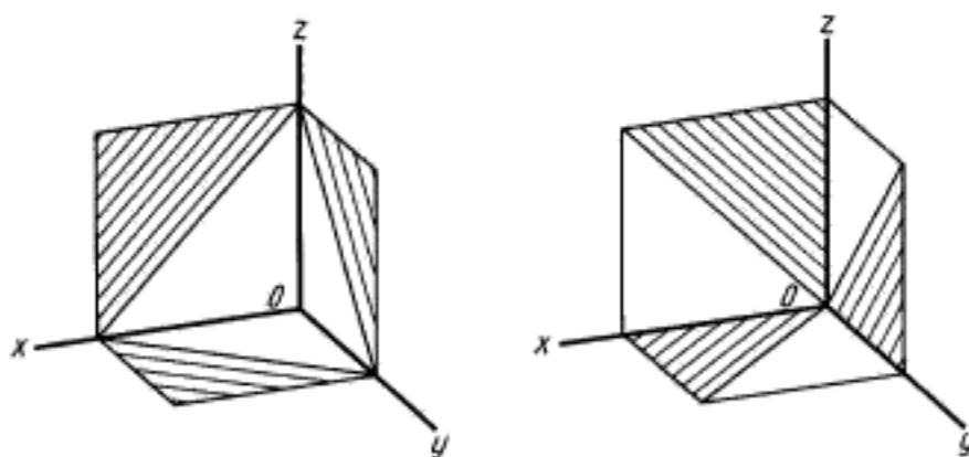
Рисунок А.1 — Нанесение линий штриховки в сечении
